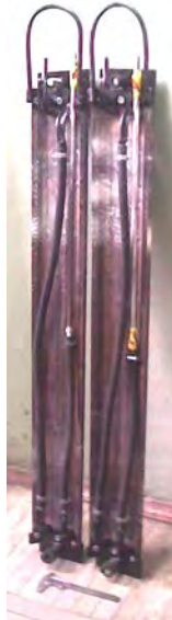
Рис. 4. Внешний вид усовершенствованной конструкции водоохлаждаемых накладок для формирования обратной поверхности электрошлакового шва.
